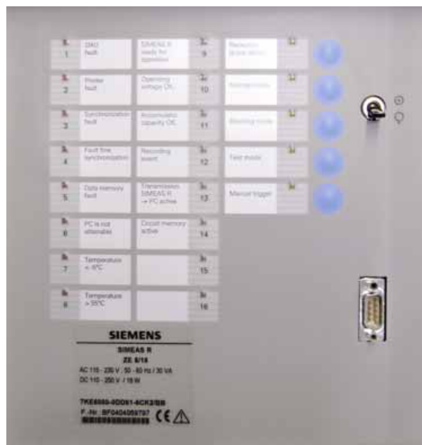
Bild 6/10 LEDs und Steuertasten
