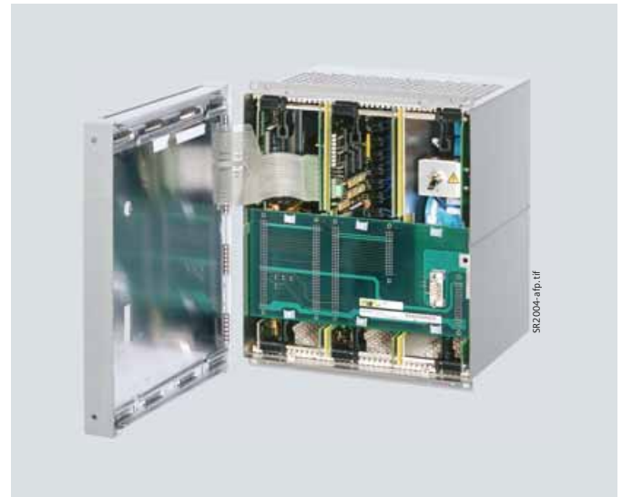
Bild 5/6 Aufbau eines SIMEAS R-PQ
