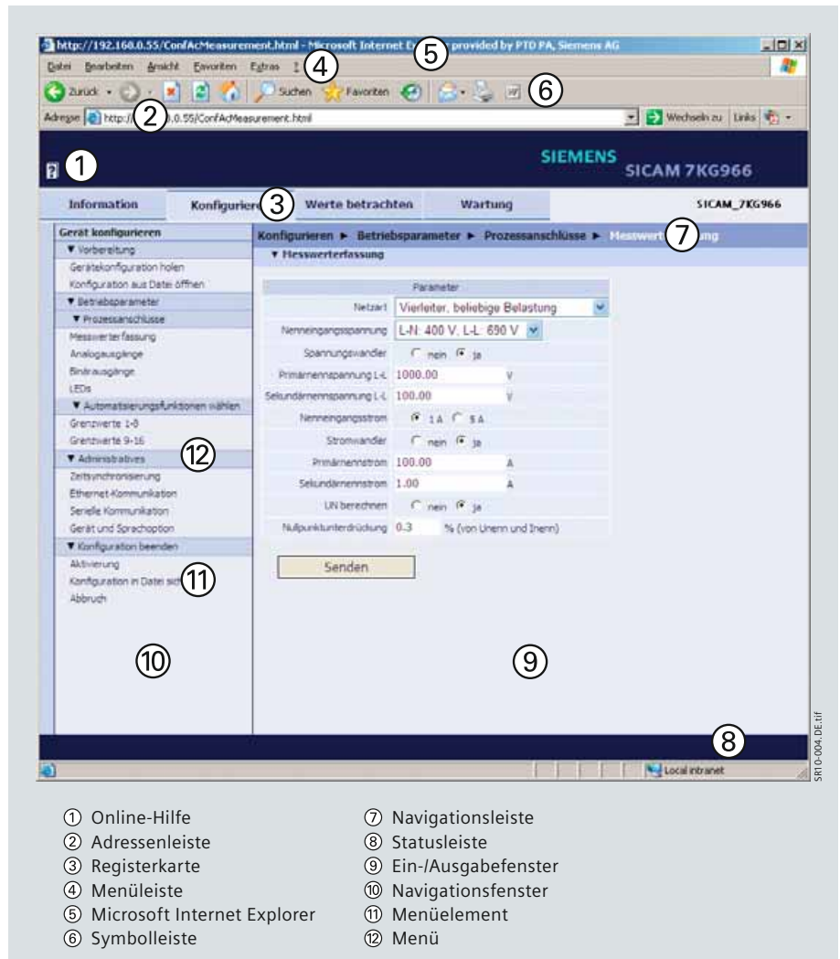
Bild 3/7 Aufbau der Benutzeroberfläche SICAM T GUI
