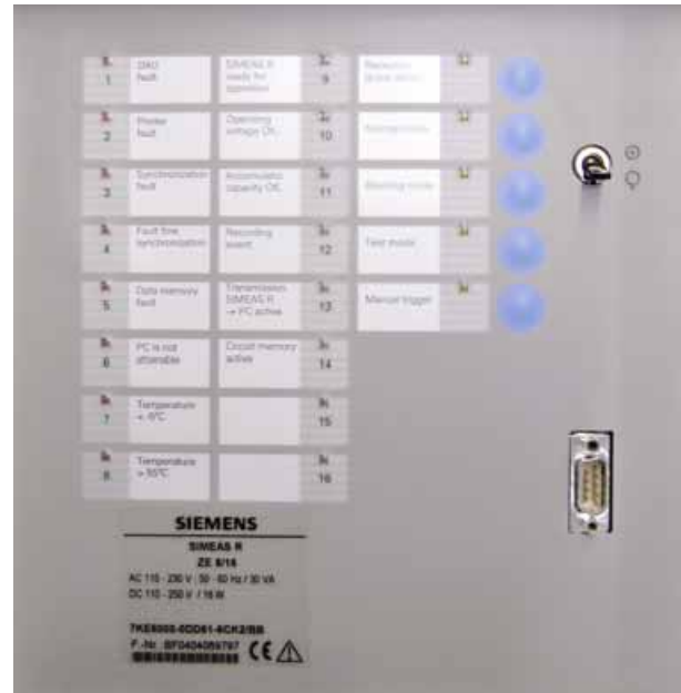
Bild 5/8 LEDs und Steuertasten
